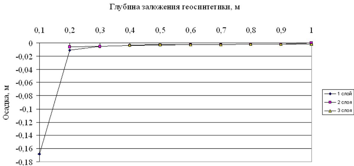
Рис. 5. Изменение осадки поверхности при провале грунта при отсутствии полезной нагрузки в зависимости от глубины заложения армирующих прослоек на примере модели грунта №10; нормальная жесткость геосинтетического материала 7000 кН/м
